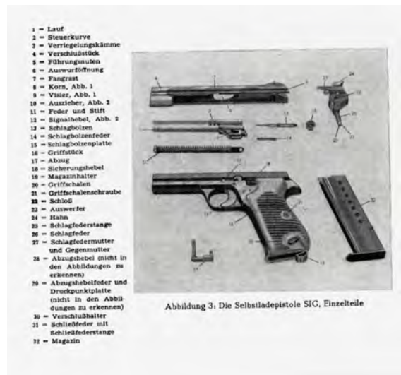
Abbildung 3: Die Selbstladepistole SIG, Einzelteile
