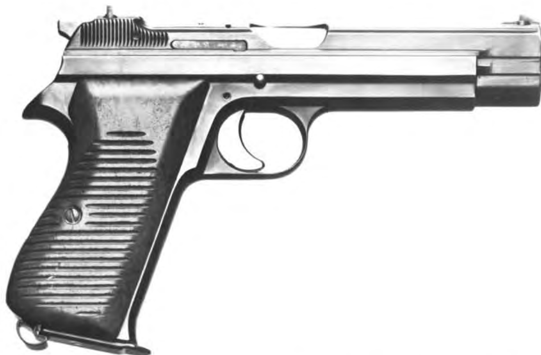
S.P. 47/8, privates Schwedenmodell, Waffennummer 6573, Kaliber 7,65 mm mit Privatfutteral, Schwedenmodell Ausführung 2, dritter Teil-Nummernbereich, 1947
