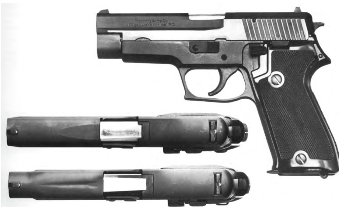
Zum Vergleich der Schlittenoberseite: oben BDA, unten Original-P 220
