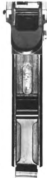
Vergleich: ovale Ausfräsung zur Auflage der Schlagfederstange bei späterer Schweden-SIG
