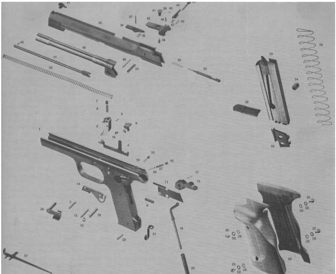
Explosionszeichnung der P 240 mit Bezeichnung der Einzelteile
