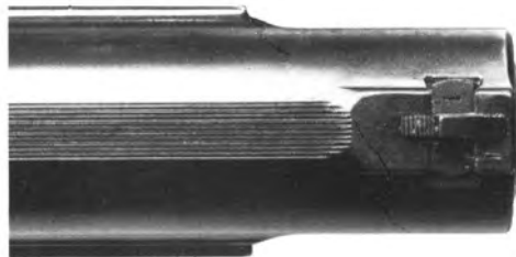
Vergleich: ovale Ausfräsung zur Auflage der Schlagfederstange bei späterer Schweden-SIG
