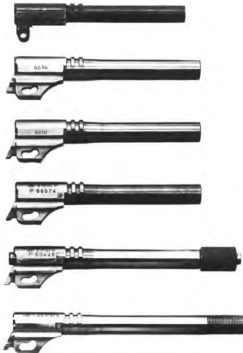
Original-Petter-Lauf Schwedenlauf mit kurzem Patroneneinlauf Schwedenlauf mit langem Patroneneinlauf Normal P 210-Lauf (heutige Ausführung) 4-mm-Einstecklauf 150 mm-Sportlauf
