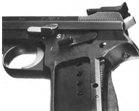
Schloss seitlich und hinten verschraubt
