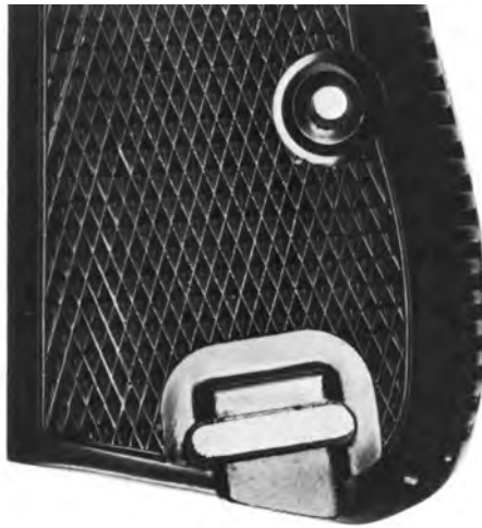
Aussparung für Riemenbügel nachträglich maschinell ausgefräst (Ausführung 1)
