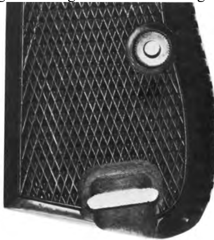
Aussparung für Riemenbügel nachträglich maschinell ausgefräst (Ausführung 1)
