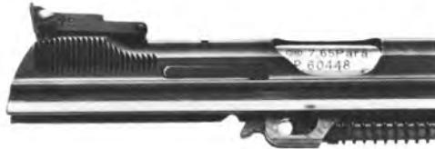
Grosse Verstelle schraube am Visier mit »R«
