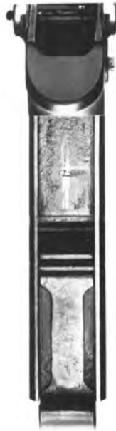
Griffstück ohne Ausfräsung für Schlagfederstange
