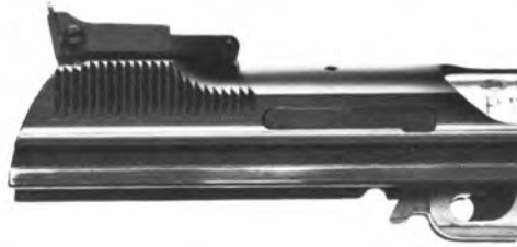
Kleine seitliche Verstelle schraube beim heutigen Mikrovisier
