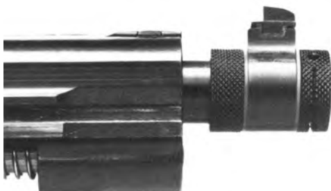
Kornsattel mit Rundmuttern in alter Ausführung (geriffelt)
